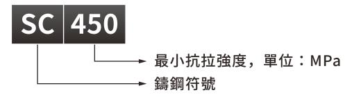
(B) 高強度碳鋼、低合金鋼鑄件
