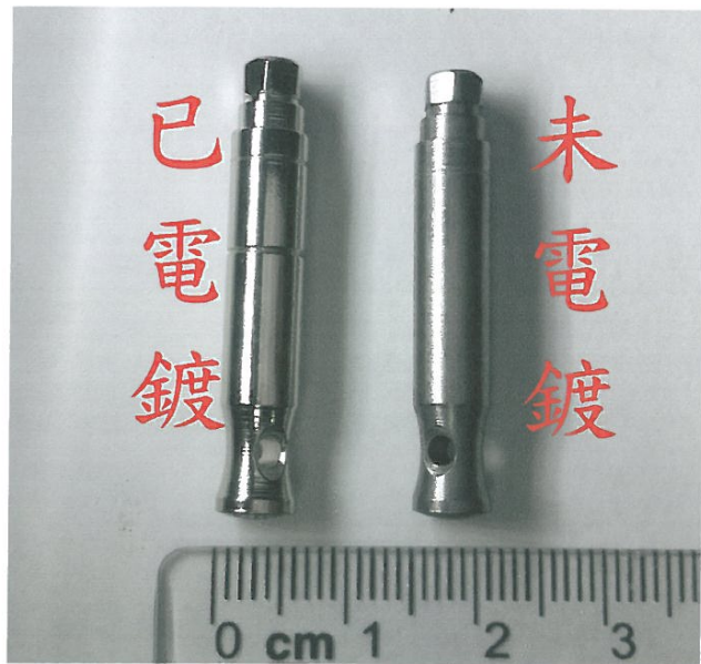
圖(1)表面已/未電鍍不良樣品外觀 圖(2)表面已電鍍不良樣品外觀 10X
