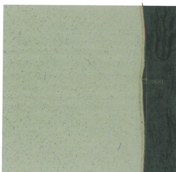
圖(3)表面未電鍍不良樣品外觀 10X 圖(4)表面已電鍍不良樣品深度量測
