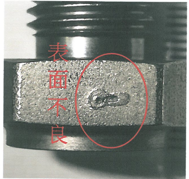
圖(2)表面不良樣品外觀 X10
