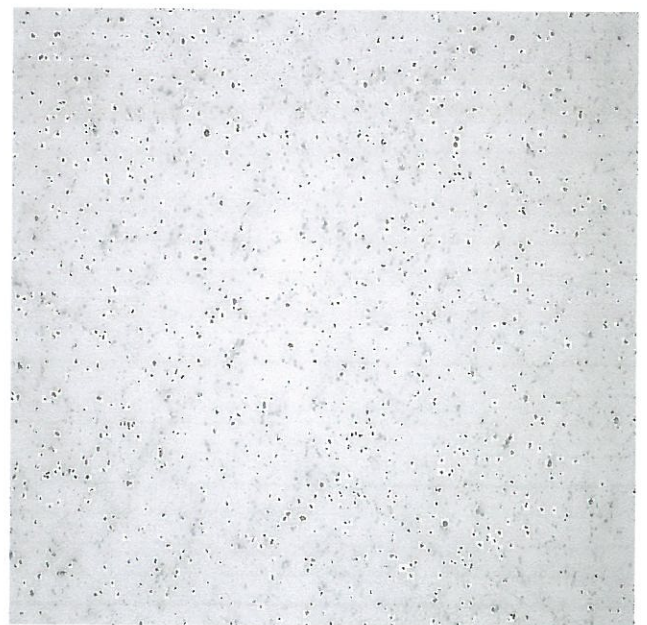
圖(4)表面不良樣品 金相橫切面 200X
