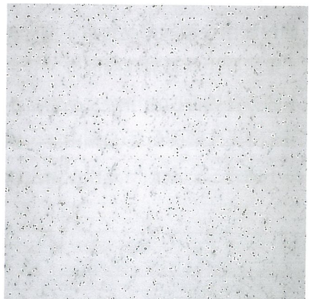
圖(4)表面不良樣品 金相橫切面 200X
