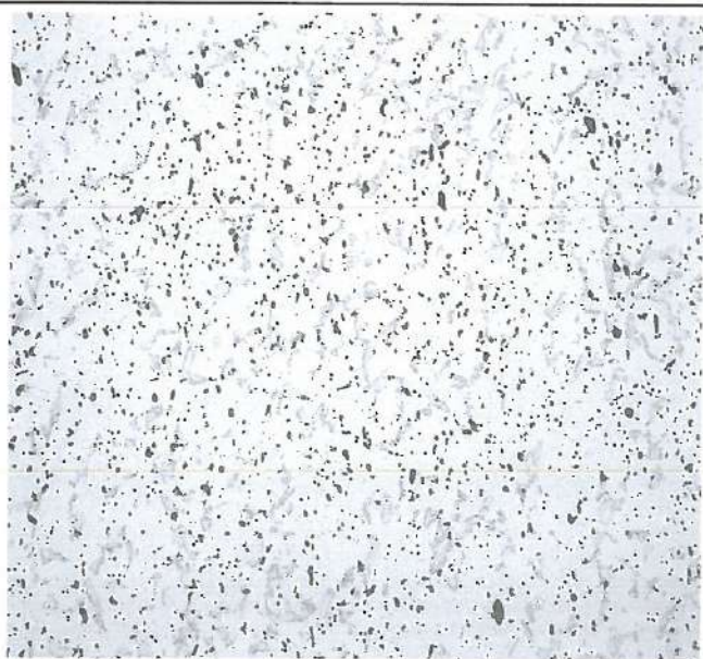
圖(7)表面不良樣品金相橫切面 500X Picral
