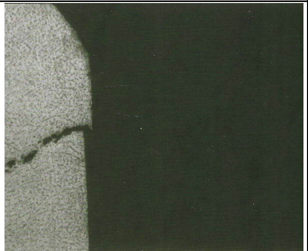
fig(6) 金相橫切面_100X 腐蝕液：苦味酸
