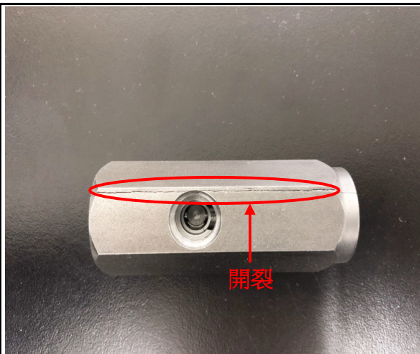
fig(1) 開裂外觀
