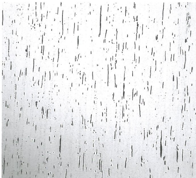
圖(5)表面不良樣品金相切面 100X
