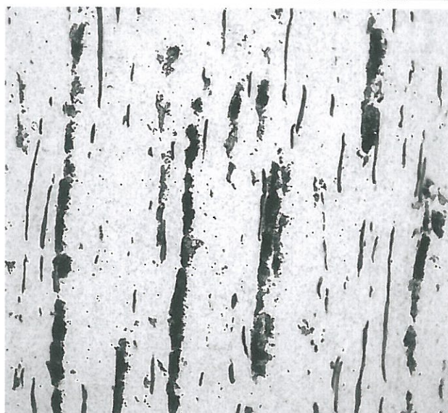
圖(6)表面不良樣品金相切面 500X Picral
