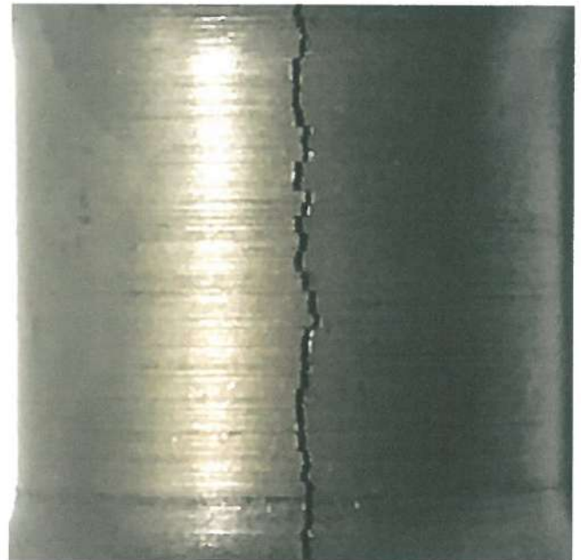
圖(2)開裂樣品外觀 10X
